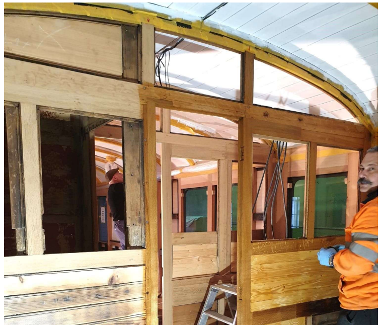
Anbringen der Lasur an sichtbaren Eichenhölzern
